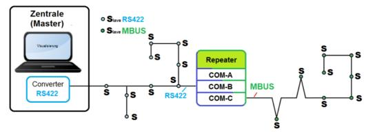
COM-B = RS422 module COM-C = MBusMaster08 module
