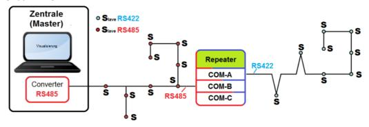
COM-A = RS422 module COM-B = RS485 module
