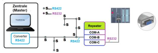
COM-B = RS422 module COM-C = RS232 module
