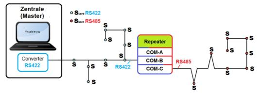
COM-B = RS422 module COM-C = RS485 module
