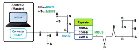
COM-B = RS422 module COM-C = MBusMaster80 module
